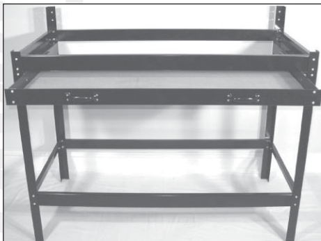
16) Työnä koottu laatikko paikalleen ohjauksiskoja pitkin (21 ja 22).
