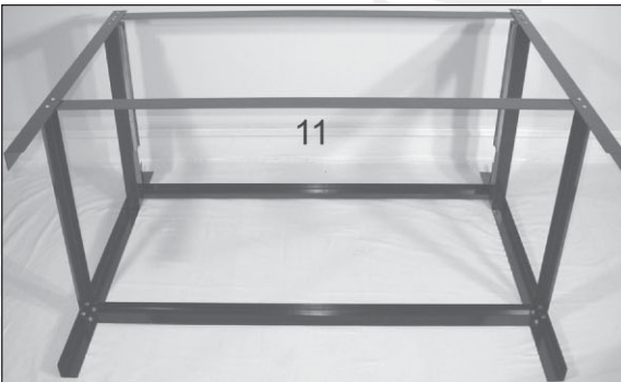
14) Kiinnitä toinen ristikkäiskappale etujalkojen väliin.
